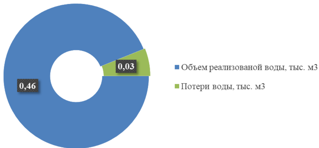
Рисунок 4 – Общий баланс подачи и реализации холодной воды
